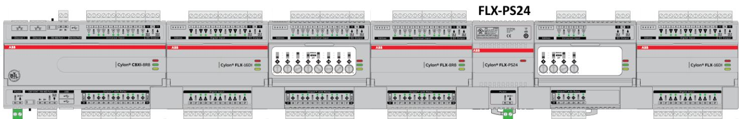
FLX-PS24 facilita la connessione remota di moduli I/O FLX a CBXi o CBX fino a una lunghezza totale massima di 1200 m (3280 ft). Ogni FLX-PS24 può alimentare un segmento di bus fino a 30 m (100 piedi):
