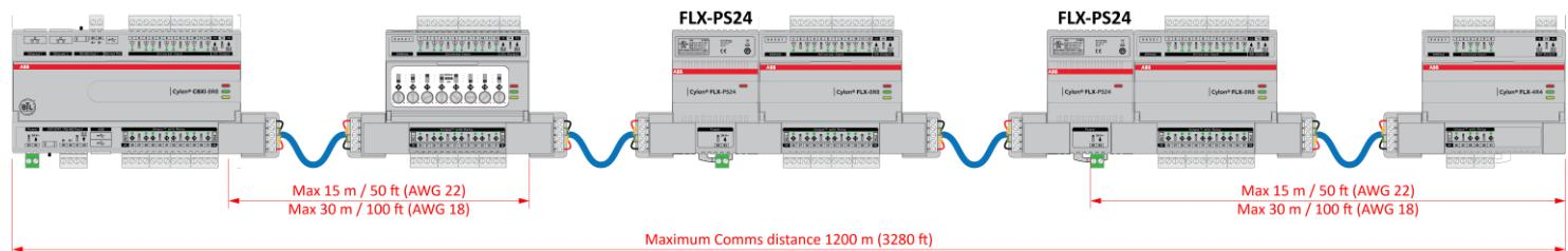
FLX-PS24 può fornire alimentazione da 20 V DC montata su guida DIN per dispositivi di campo esterni utilizzando FLX-RMC:
