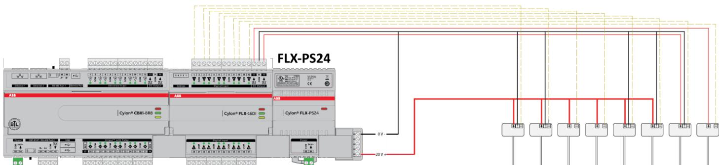
Il numero di moduli I/O FLX che possono essere alimentati da un FLX-PS24 dipende dal modello e dal carico dei singoli moduli I/O FLX. È possibile utilizzare qualsiasi combinazione la cui potenza totale a pieno carico sia inferiore a 20 W. La tabella del consumo energetico qui di seguito mostra il carico di potenza di ciascun moduli I/O FLX::
