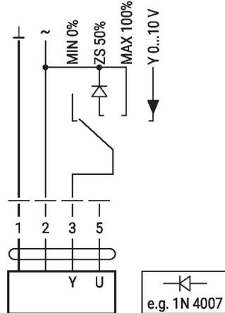
Commande à distance 0...100% avec positionneur SG.
