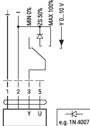
Commande à distance 0...100% avec positionneur SG.
