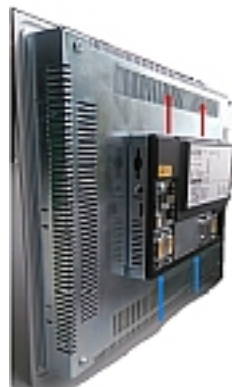
Abb. 4: Luftzirkulation zur Kühlung
