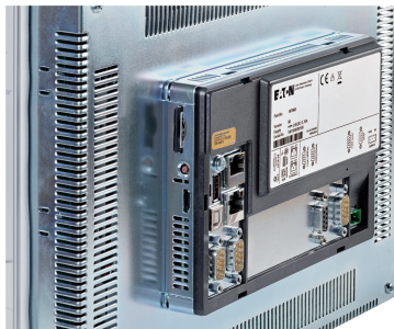
Abb. 18: SD-Karte im Slot eingesetzt, noch nicht eingerastet
