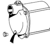
Wenn die Installation längere Zeit nicht benutzt wird, entleeren Sie die Pumpe, reinigen Sie sie und lagern Sie sie (siehe 2.3).
