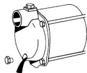
Se houver risco de congelamento, drenar a bomba desapertando o tampão de drenagem.
