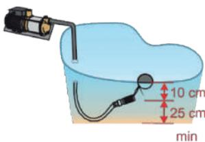
Elegir el punto de aspiración de forma que la bomba reciba siempre agua limpia y no contaminada. La bomba no debe aspirar sedimentos del suelo. Es aconsejable colocar un filtro con un tamaño de malla de entre 1 y 3 mm.
