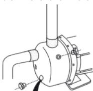
Wenn die Installation längere Zeit nicht benutzt wird, entleeren Sie die Pumpe, reinigen Sie sie und lagern Sie sie (siehe 2.3).
