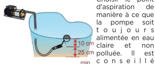
Choisir le point d'aspiration de manière à ce que la pompe soit toujours alimentée en eau claire et non polluée. Il est conseillé d'équiper l'orifice d'aspiration d'une crête à maille comprise entre 1 et 3 mm.
