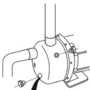
Als het systeem lange tijd niet wordt gebruikt, moet de pomp worden afgetapt, gereinigd en opgeslagen (zie 2.3).
