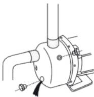
Se a instalação não for utilizada durante um longo período de tempo, drenar a bomba, limpá-la e guardá-la (ver 2.3).
