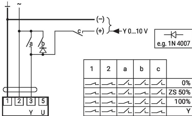
Commande forcée avec commutateur rotatif AC 24 V
