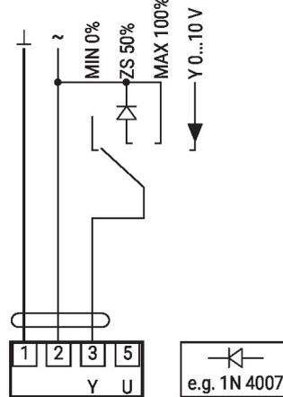
Commande à distance 0...100% avec positionneur SG.
