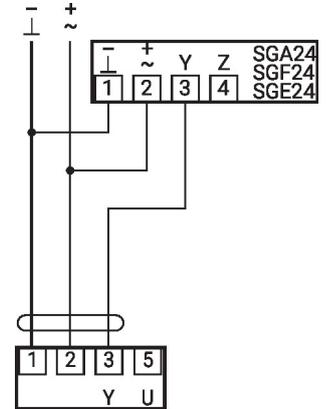
Limitation minimale avec positionneur SG.
