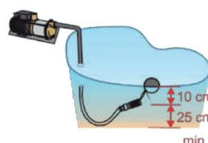
D e ondergedompelde aanzuigopening moet zo worden geplaatst dat de pomp wordt voorzien van helder, niet-verontreinigd water. Het is aangeraden om een filter te gebruiken met een maaswijdte tussen 1 en 3 mm.
