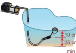
O orifício de aspiração submerso deve ser posicionado de modo a abastecer a bomba com água limpa e não contaminada. É aconselhável equipá-la com um filtro com uma malha entre 1 e 3 mm.
