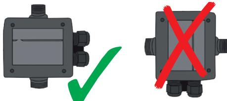
Dans le cas d'une utilisation avec pompe immergée, ne pas installer dans le réservoir de la pompe:
