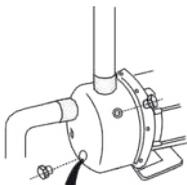
Si la instalación no se utiliza durante un periodo prolongado, drenar, limpiar y almacenar la bomba (ver 2.3).
