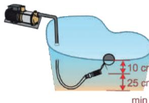
La bocchetta di aspirazione s o m m e r s a deve essere posizionata in modo da fornire alla pompa acqua limpida e non contaminata.
