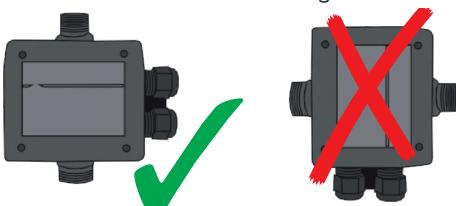
Voor gebruik met een dompelpomp, niet installeren in de pomptank:
