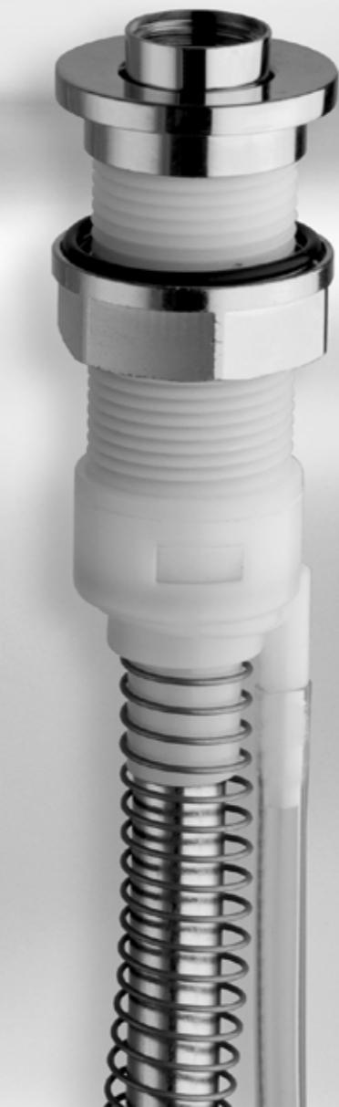
IT Il dispositivo permette di drenare l'acqua che, durante e dopo il normale utilizzo della doccetta, scende dal flessibile nella parte sottostante la vasca. L'acqua viene convogliata direttamente nel sottopiletta della colonna di scarico per mezzo di un tubo di plastica che collega la parte inferiore dello sgocciolatoio allo scarico vasca.
