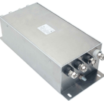
PLC Line Filter LCF-250-PC Der PLC Line Filter trennt die Kommunikationsdomänen der Stromleitungen in kommerziellen Enphase-Installationen, wenn sich mehrere IQ Gateways an einem einzigen Versorgungstransformator befinden oder wenn die Lasten vor Ort zu viel elektrisches Rauschen erzeugen. Ermöglicht bzw. verbessert die PLC-Kommunikation, wenn die Lasten vor Ort oder das Netz Störungen verursacht.
