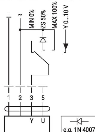
Commande à distance 0...100% avec positionneur SG.
