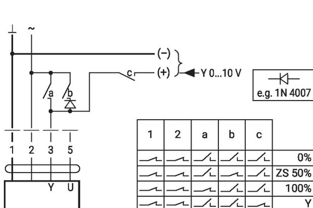
Commande forcée avec commutateur rotatif AC 24 V
