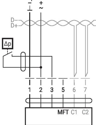
Exigences relatives au contact de commutation : le contact de commutation doit pouvoir commuter un courant de 16 mA à 24 V avec précision. Le début de la plage de travail doit être paramétré sur le servomoteur MOD à  $\geq 0,5$  V.
