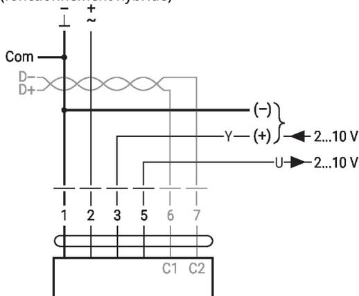
Raccordement avec capteur actif, par exemple 0 - 10 V @ 0 - 50 °C
