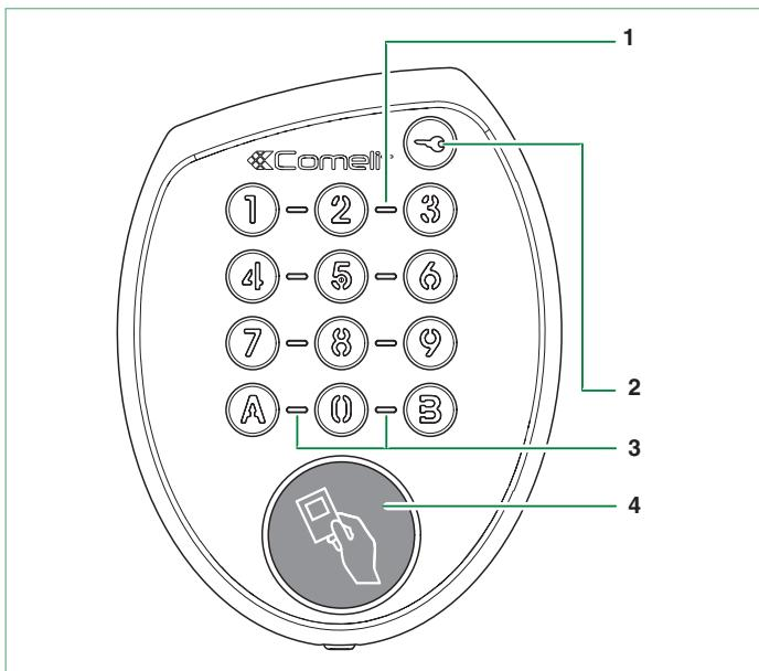
**IT** 1. **Spira di stato:** Indica mediante colori differenti il risultato dell'azione effettuata:
