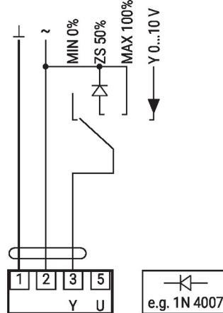
Commande à distance 0...100% avec positionneur SG.
