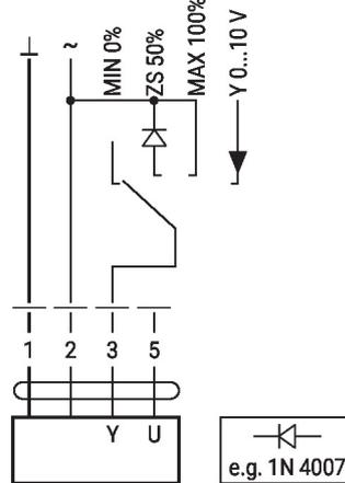
Commande à distance 0...100% avec positionneur SG.
