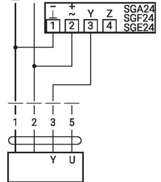
Limitation minimale avec positionneur SG.
