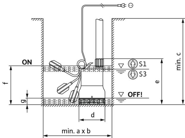
Fig. 2: Dimensões de instalação e pontos de comutação
