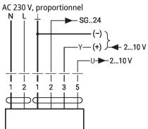
Alimentation auxiliaire uniquement pour positionneur SG.. 24
