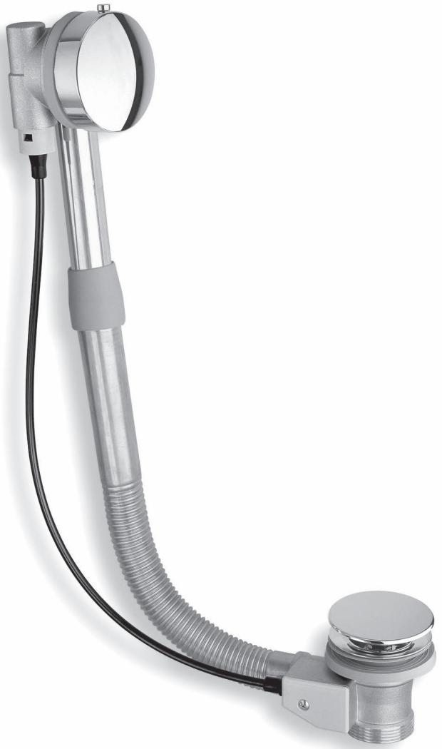
IT Scarico per vasca in ottone e rame. Tubo corrugato in rame Ø 34 mm. Movimento a cremagliera.
