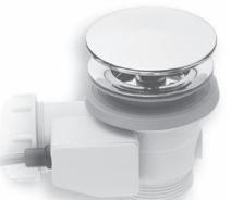
IT Le guarnizioni sono realizzate in PP/EPDM e risultano tutte perfettamente compatibili con i materiali acrilici. La particolare guarnizione doppia montata al sottopiletta evita infiltrazioni d'acqua nei materiali porosi, quali il vetroresina, ed evita l'utilizzo di prodotti siliconici durante l'installazione.
