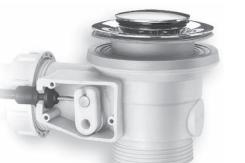
IT La guaina di trasmissione realizzata in PA66 (materiale nylon ad alte prestazioni) con terminali co-stampati è fissata al corpo del tropo pieno e del sottopiletta con un sistema a pressione senza l'ausilio di blocaggi meccanici che potrebbero determinare imprecisioni nel tempo e risulta perfettamente inamovibile.
