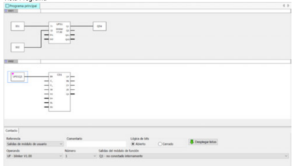
Fig. 279: Cableado de las entradas/salidas
