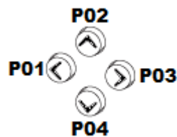
Fig. 113: Las teclas de cursor se cablean en el esquema de contactos como contactos P 01 a P 04.
