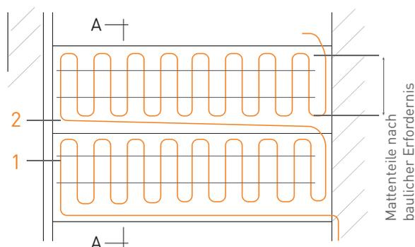
1 werkseitig gefertigte Heizmatte    2 heizende Verbindung
