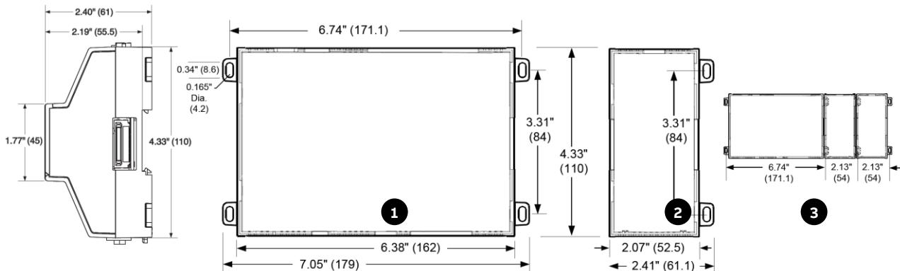
IT-8000 控制器。与所有侧面至少 1.5 英寸（38 毫米）间隙，底部距 Wi-Fi 天线最少 3 英寸（76 毫米）
