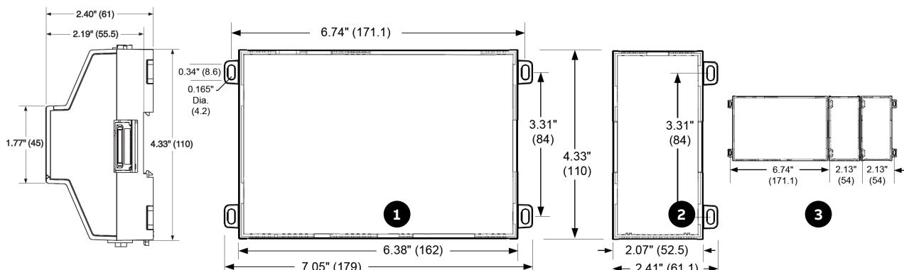
1 Контроллер IT-8000. Требуется зазор не менее 1,5" (38 мм) со всех сторон и не менее 3" (76 мм) в нижней части для антенны Wi-Fi
