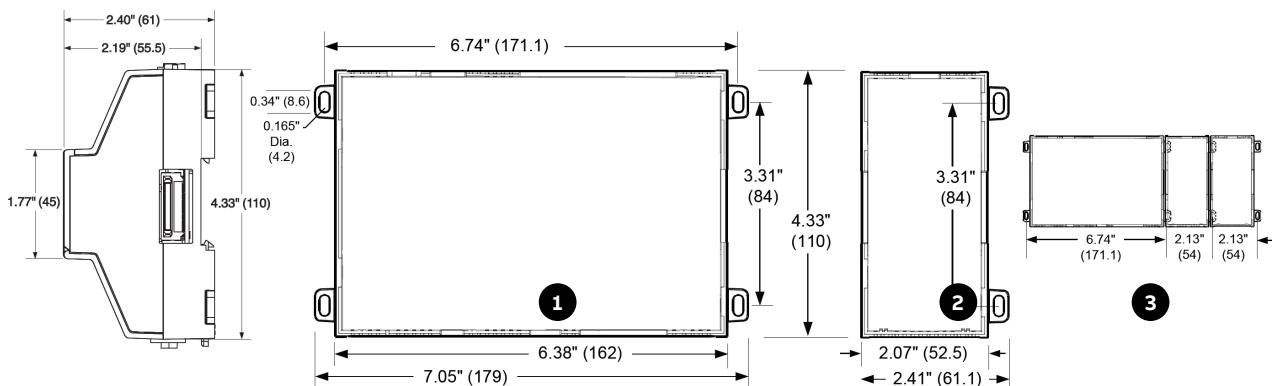
Controlador IT-8000. Permitir al menos un espacio de 38 mm (1,5") en torno a todos los lados y un mínimo de 76 mm (3") al fondo para la antena Wi-Fi
