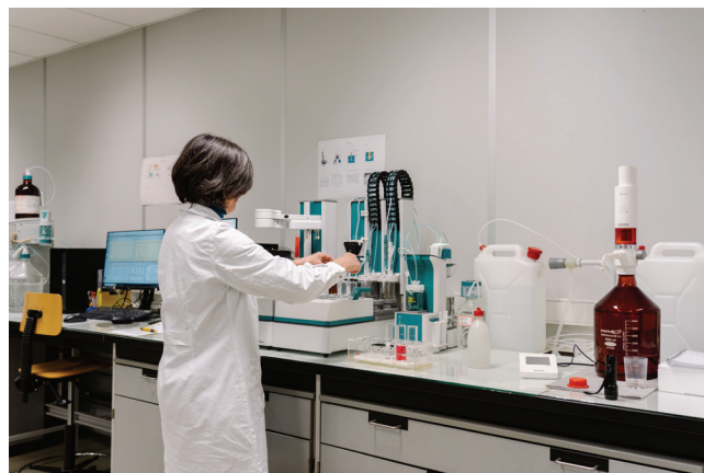
Titratoren zur präzisen Messung von pH-Wert, Leitfähigkeit und Alkalinität.
