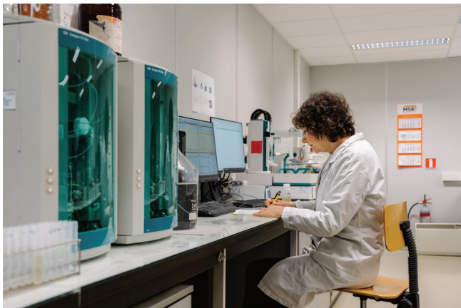
Ionenchromatograph zur Bestimmung verschiedener Kationen und Anionen.
