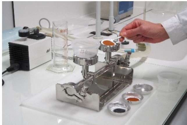
Detaillierte Analyse von Ablagerungen oder Feststoffen im Systemwasser.
