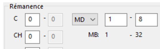
Fig. 274: Extrait rémanence : octets de mémoires internes 1 à 32 saisis et représentation en mots doubles de mémoires internes après un autre basculement dans l'onglet Réglages du système
