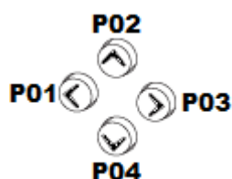
Fig. 112: Ces touches de direction sont câblées dans le schéma de commande en tant que contacts P 01 à P 04.
