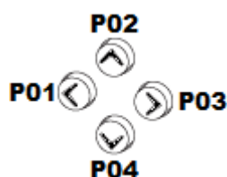
Fig. 112: Nello schema elettrico i tasti cursore sono cablati come contatti da P 01 a P 04.
