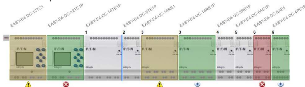
Fig. 312: Vista Proyecto EN LÍNEA con aparatos en color distintos en función de la compatibilidad
