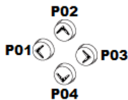
Fig. 112: Las teclas de cursor se cablean en el esquema de contactos como contactos P 01 a P 04.
