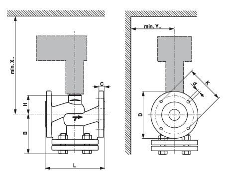
X/Y: Distance minimum par rapport au milieu de la vanne. Les dimensions du servomoteur sont indiquées dans la fiche technique correspondant au servomoteur.
