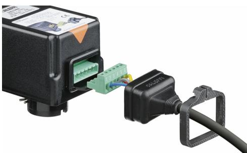
Die elektrische Verbindung des Motors erfolgt durch ein externes System Steckdose/Stecker, ohne die Abdeckung entfernen zu müssen. Nach dem Einsticken des Steckers die Schutzhülle aus Gummi in ihren Sitz, d.h. in die entsprechende Nut im Deckel, gleiten lassen. Danach muss die Schutzhülle wie in dem Bild befestigt werden und mit Schraubenzieher angezogen werden.
