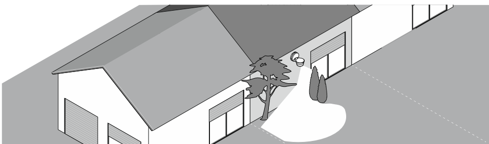
Afb. 23: Wandmontage bij tussenwoning voor beperkte detectieradius 6851/9-xxx
