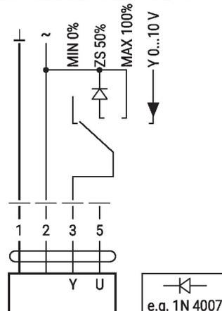
Commande à distance 0...100% avec positionneur SG.
