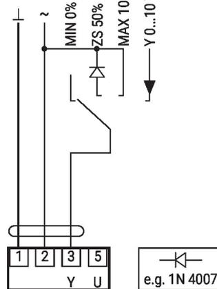
Commande à distance 0...100% avec positionneur SG.
