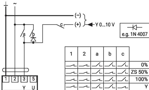
Zwangssteuerung mit AC 24 V mit Drehschalter
