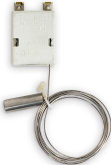
Der Maximaltemperaturbegrenzer KRU ist ein mechanischer Kapillarrohrfühler zur Begrenzung von Fußbodentemperaturen für die Speicher- und Ergänzungsheizung oder auch unter Laminatfußböden. Der KRU eignet sich zum Einbau in ein UP-Dose 100 / 100. Schaltstrom: 16 A, Temperaturbereich: 10 - 60 °C, fixe Fühlerleitungslänge: 1.5 m.
