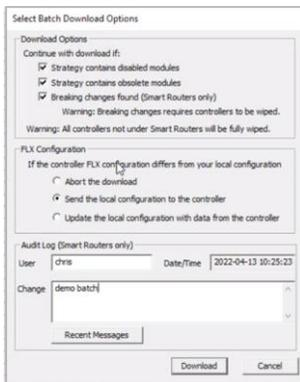
4. Klicken Sie auf **Download**. Der Download wird für die ausgewählten Geräte ausgeführt, wobei Konflikte angezeigt werden und eine Fehlermeldung ausgegeben wird, wenn eine oder mehrere Bedingungen
