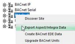
Wenn ein Feldregler ausgewählt wird, werden die Informationen dieses Controllers in eine .json-Datei für ASPECT® / INTEGRA™ exportiert, wie auch die Informationen des übergeordneten Netzwerks und des übergeordneten Standorts, die für einen korrekten Import in ASPECT® oder INTEGRA™ erforderlich sind.
