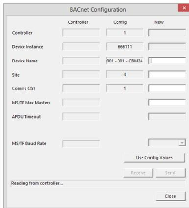
**Hinweis:** Wenn der Engineering-PC über Ethernet verbunden ist, können nur die Parameter **Device Name**, **Router Address** und **MSTP Max Masters** geändert werden. Um andere Parameter bearbeiten zu können, muss der Engineering-PC über die serielle RS232-Schnittstelle verbunden sein.
