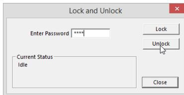
Wenn die Blöcke im Controller erfolgreich entsperrt wurden, wird eine Meldung im **Lock/Unlock**-Dialog angezeigt.
