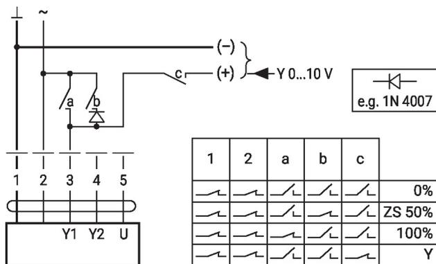
Zwangssteuerung mit AC 24 V mit Drehschalter
