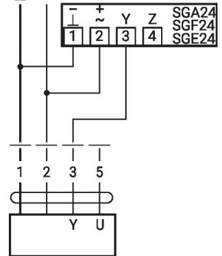
Limitation minimale avec positionneur SG.
