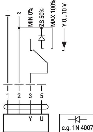
Commande à distance 0...100% avec positionneur SG.
