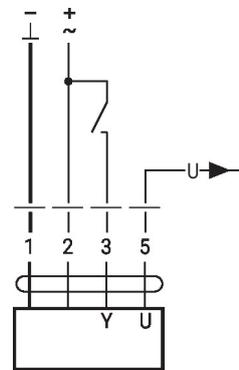
Commande forcée et limitation avec alimentation AC 24 V par un commutateur rotatif
