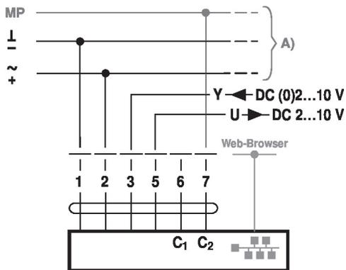
BACnet IP / Modbus TCP avec consigne analogique (mode hybride)
