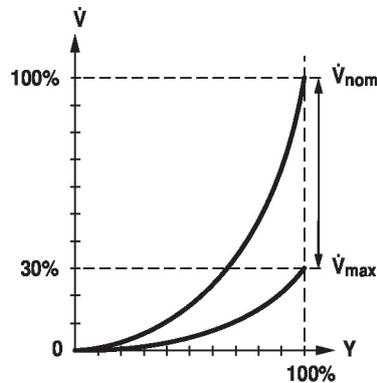
**Limite de mesure** Compte tenu de la vitesse d'écoulement très faible dans la phase d'ouverture, ce n'est plus mesurable par le capteur avec la tolérance requise. Cette plage sera masquée électroniquement.
