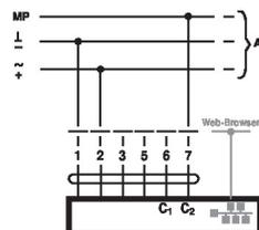
MP-Bus, alimentation via un raccordement à 3 fils
