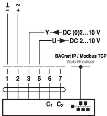
MP-Bus, alimentation via un raccordement à 3 fils
