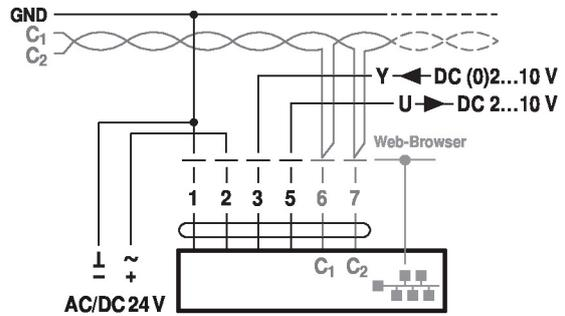
MP-Bus, via un raccordement à 2 fils, alimentation locale
