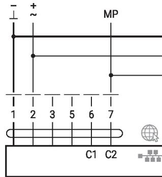
BACnet MS/TP / Modbus RTU avec consigne analogique (mode hybride)
