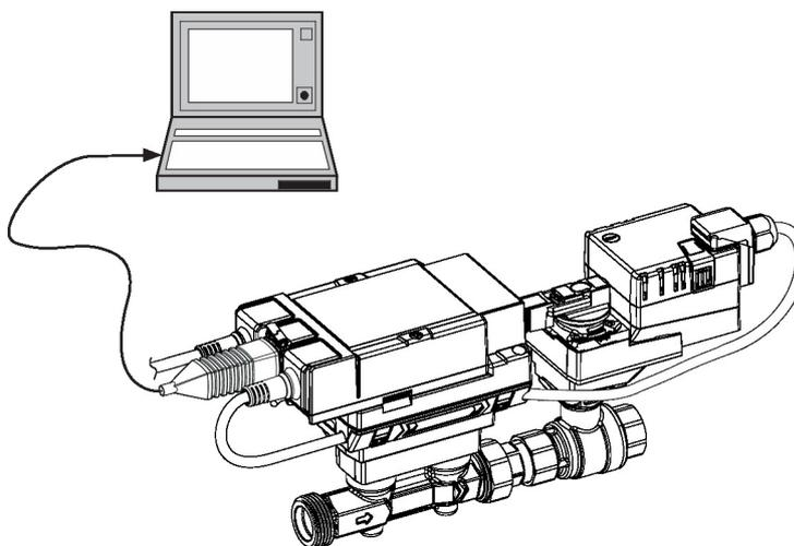
**Inversion du signal de commande** Le signal de commande peut être inversé en cas d'utilisation d'un signal analogique.
