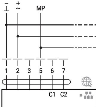
MP-Bus, via un raccordement à 2 fils, alimentation locale
