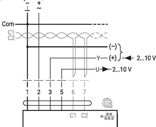
BACnet/IP / Modbus TCP avec point de consigne analogique (mode hybride)
