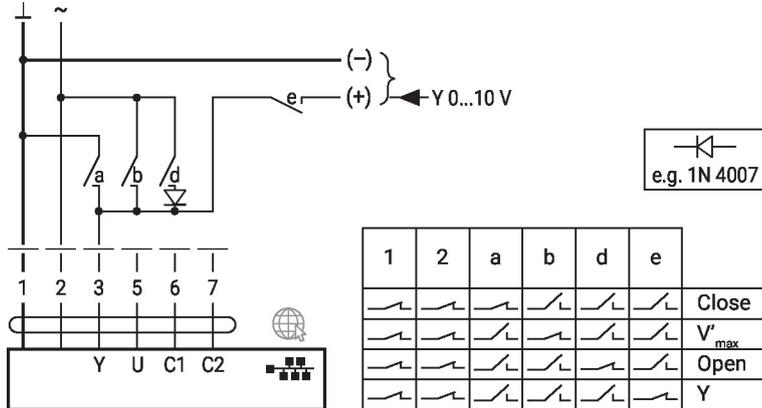
Commande forcée et limitation avec alim. DC 24 V par des contacts relais (avec commande classique ou hybride)
