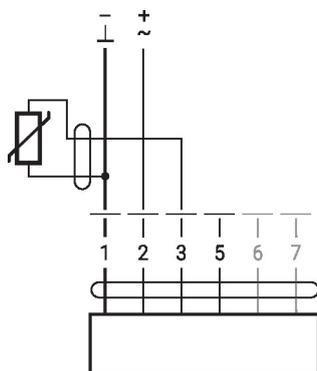
Raccordement avec contact de commutation
