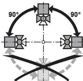
**Site d'installation sur le retour** Installation sur le circuit de retour recommandée
