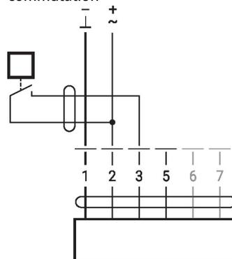
Raccordement avec capteur actif
