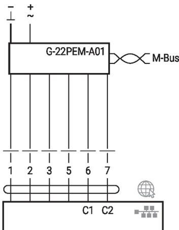
M-Bus parallèle, Modbus TCP ou BACnet/IP avec PoE
