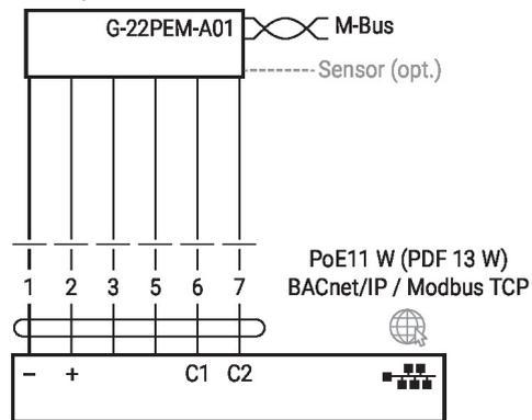
M-Bus parallèle, Modbus RTU ou BACnet MS/TP
