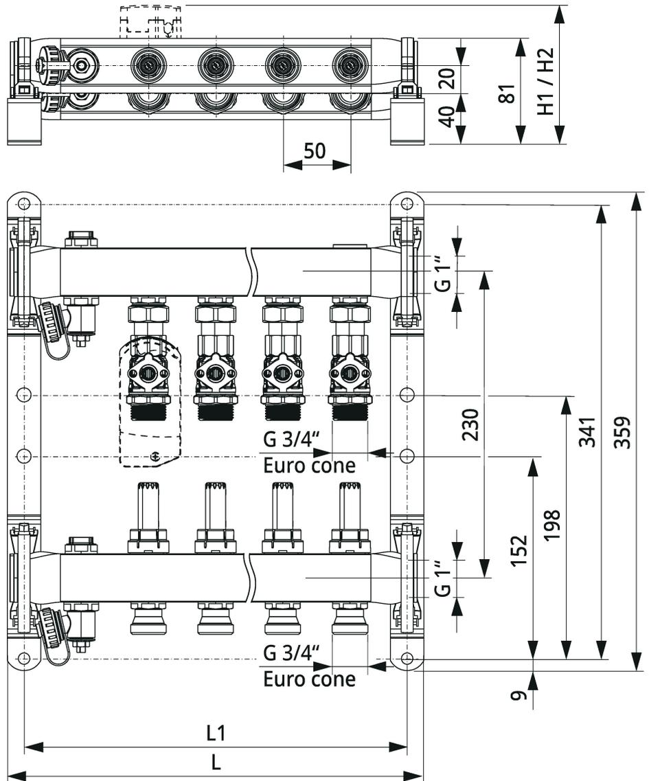
Les dimensions du servomoteur sont de H1 (CQ.....A..) 105 mm et H2 (CQK...A..) 109 mm.
