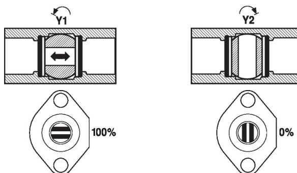
**Réglage de débit** Le débit peut être réglé avec le limiteur de débit entre 0...5 l/min.
