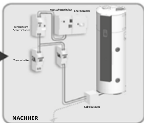
Installation der Warmwasser-Wärmepumpe
