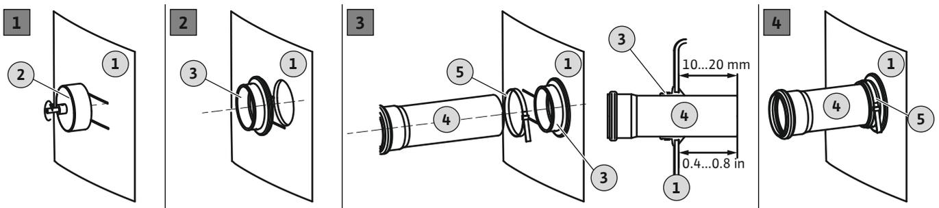
Fig. 5: 连接进水口
