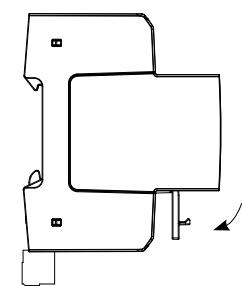
Step 2: Pull module out / Schritt 2: Modul herausziehen /
