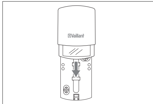
Fig. 3.7 Fixation de la sonde radio extérieure au socle mural
