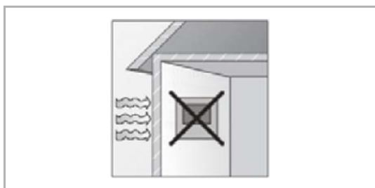
Fig. 5: Luogo di montaggio – parete esterna
