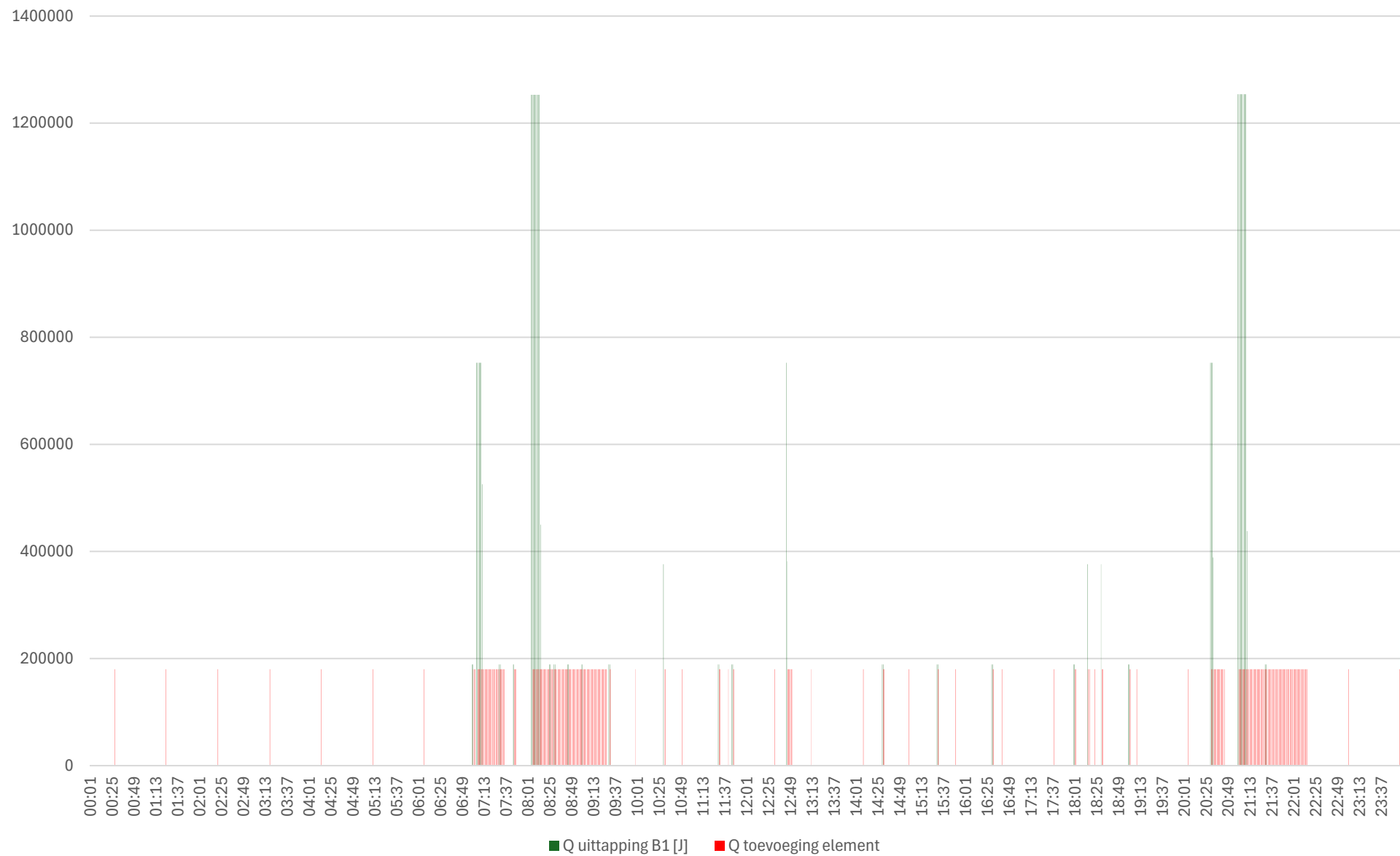
Grafiek tappatroon L (200L boiler) met opwarming door elektrisch element (conservatieve boiler)
