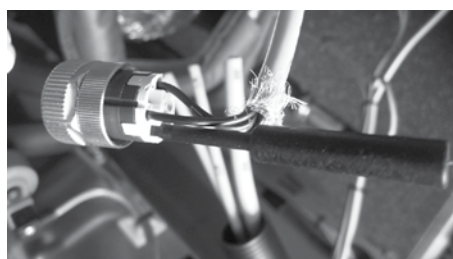
Sluit de afzonderlijke draden van de buskabel met het bijgevoegde werktuig op de stekker aan.
