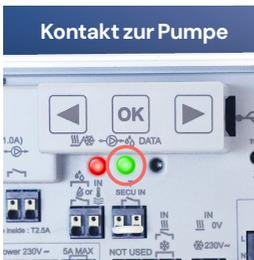
Sie können prüfen, ob die Steuerleisten korrekt gepaart sind, indem Sie eine Wärmeanforderung an der SLAVE-Regelkleimleiste erzeugen, während die andere Regelkleimleiste keine Anforderung hat, und sehen, ob sich beide Pumpenkontakte (grünes Licht) einschalten.
