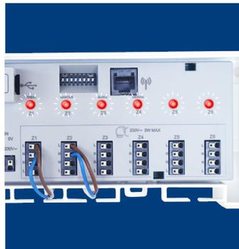
**Schritt 2** Gehen Sie nun auf die SLAVE-Regelkleimleiste. Drücken Sie **OK** bis Zone 1 zu blinken beginnt. Navigieren Sie (**◀** / **▶**) zu Zone 3 und bestätigen Sie mit **OK**.
