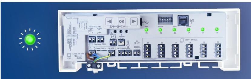
**Étape 4** Il y a un bouton d'appairage sur le module de chauffage/refroidissement (HCM), appuyez sur ce bouton et maintenez-le enfoncé jusqu'à ce que la LED clignotante s'allume en vert pendant un moment puis en rouge. Vous pouvez alors relâcher le bouton. La barre de contrôle aura quitté son mode d'appairage si l'appairage est réussi et la zone 3 clignotera en rouge (curseur).
