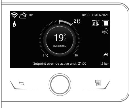
De interface van het systeem handhaalt de temperatuurwaarde tot aan de ingestelde tijd, waarna deze terugkeert tot de vooraf ingestelde kamertemperatuur.
